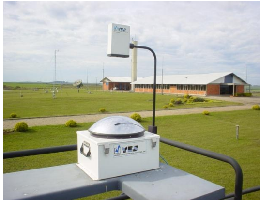
Figura 7.1. Imageador Total Sky Imager TSI-440 (YES, Inc) instalado na estação SONDA – SMS no Observatório Espacial do Sul – OES/CRS/CCR/INPE – MCT.
