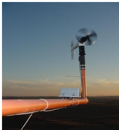
Figura 8.2. Equipamento de medida de dados eólicos da estação SONDA – SMS, instalada no Observatório Espacial do Sul – OES/CRS/CCR/INPE – MCT.
